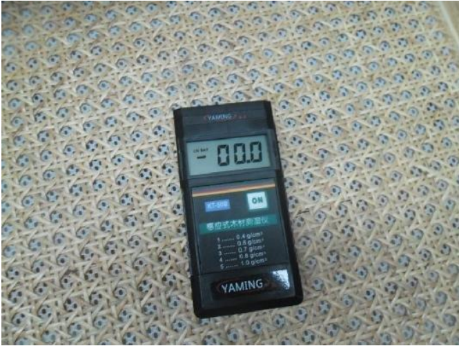
Medición humedad — higrómetro digital
